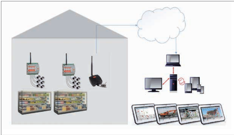
Monitoring – Überwachung der Kühlkette per Sensorik, sammeln der Daten in einem Logger und Datenübertragung per Internet zur Kältehotline
